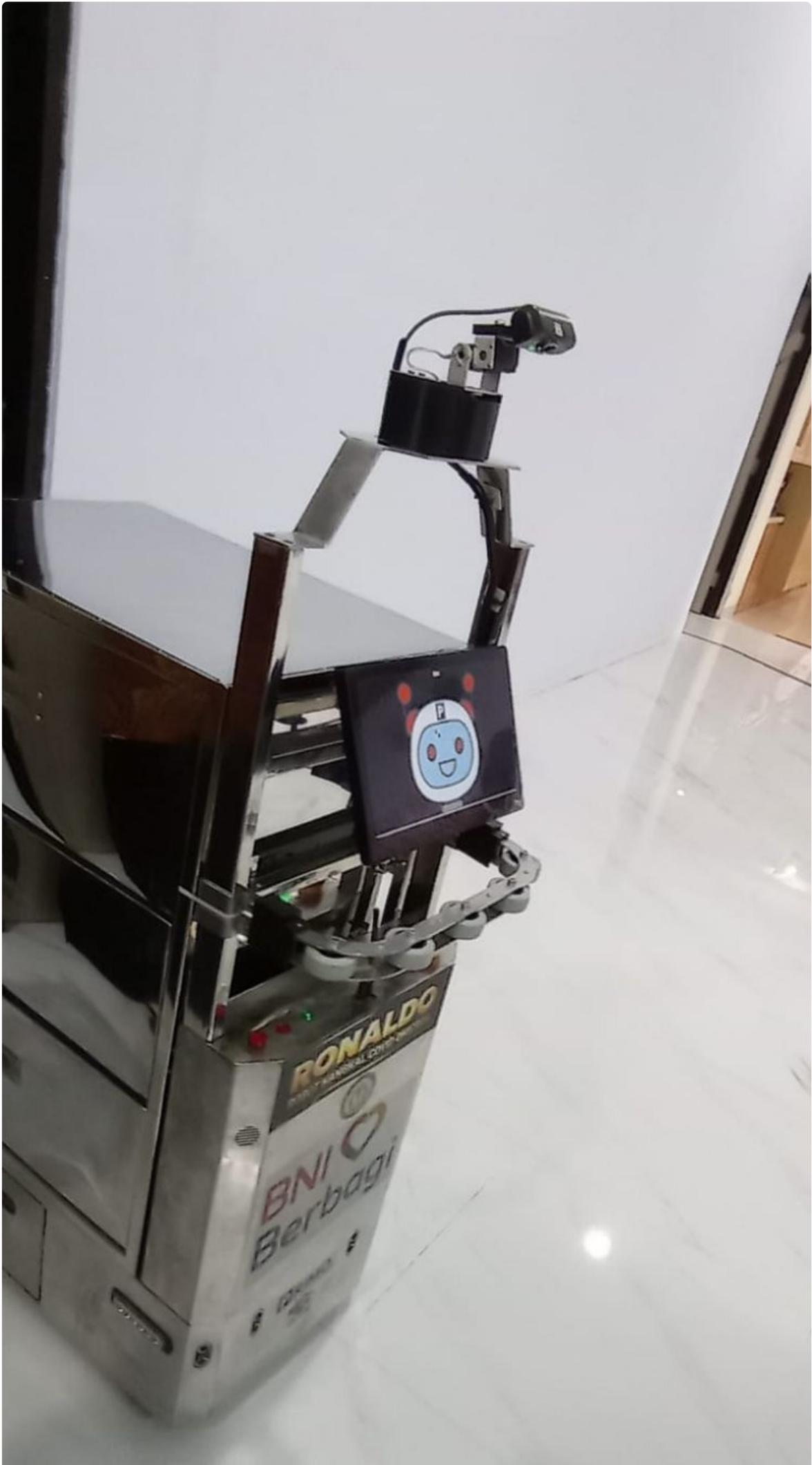
Mesin robot dengan nama Ronaldo (Robot Nangkal Covid Omicron) itu, memiliki tinggi 1,5 meter dilengkapi dengan empat rak secara bersusun yang bisa membawa banyak barang maksimal 50 kilogram.
